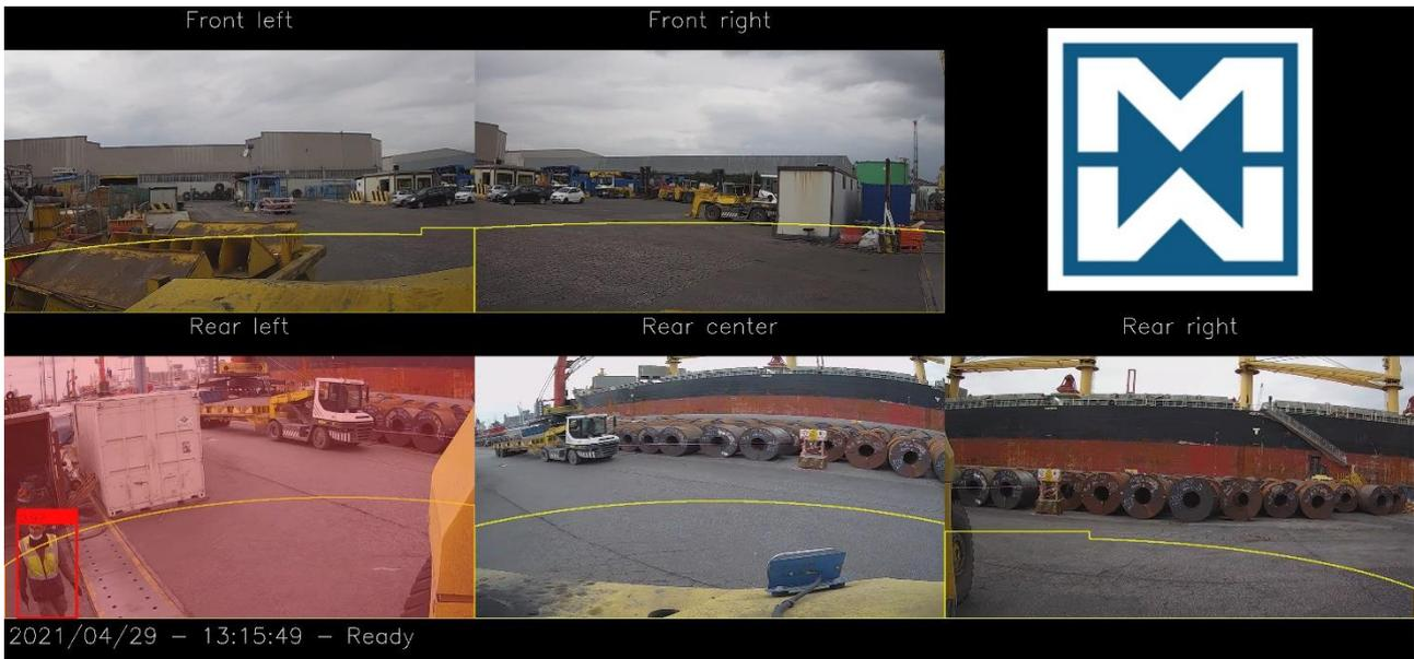
**Foto 2:** Immagine del display interno in cabina del mezzo Stacker, una delle 5 telecamere installate ha rilevato una persona, parte un segnale acustico e il riquadro della telecamera si illumina di rosso.
