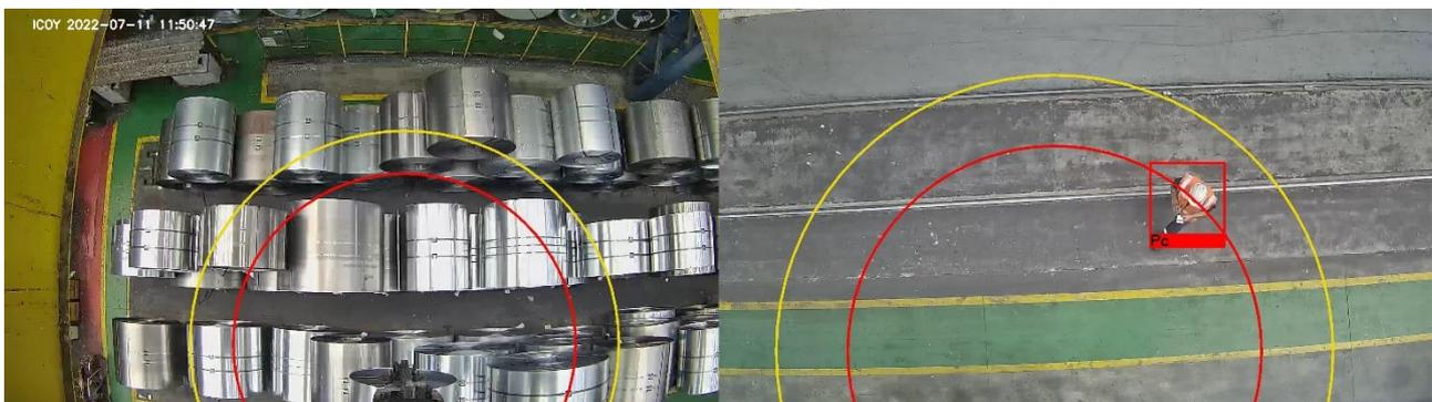
**Foto 3:** Le telecamere installate sopra il gancio del carro ponte hanno rilevato una persona nel perimetro di sicurezza, in questo caso viene attivata una sirena ambientale insieme ad un segnalatore lampeggiante luminoso ROSSO.
