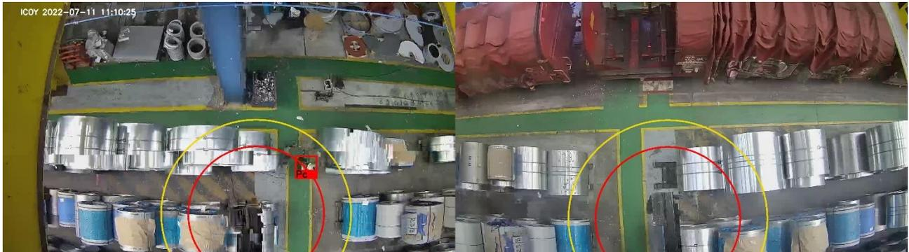
**Foto 4:** Una persona, non visibile dall'operatore a terra che comanda il carro ponte, ha invaso il perimetro di sicurezza e scatta l'allarme.
